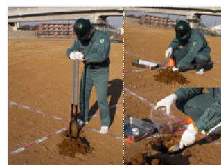
建設発生土のサンプリングの様子
